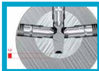
HOCHPRÄZISE FEINMECHANIK: DANK DER VERSCHIEBUNG DER SCHLÜSSELKÄNÄLE UM 0.6 MILLIMETER IST DAS SYSTEM KESO3000 FÜR VIELSEITIGSTE SCHLIESSUNGEN VORGESEHEN.
